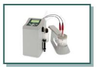
**ASTM D661** GEC-TAN Titrator
